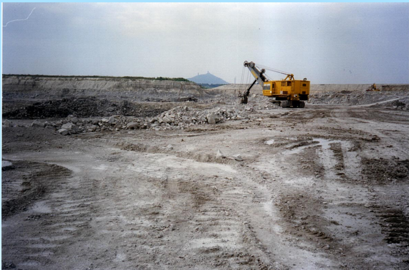
Příklad těžby nerudných surovin, ovlivňující tvářnost krajiny. Křídové slínovce z Čížkovic u Lovosic jsou využívány v cementářenském průmyslu. V pozadí hrad Hazmburk. Foto F.Reichmann.
